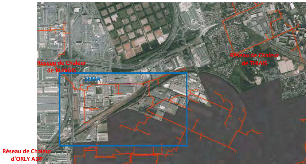
Figure 10 : extrait du plan du réseau des réseaux de chaleur d'Ile de France (Source : DRIEE)
