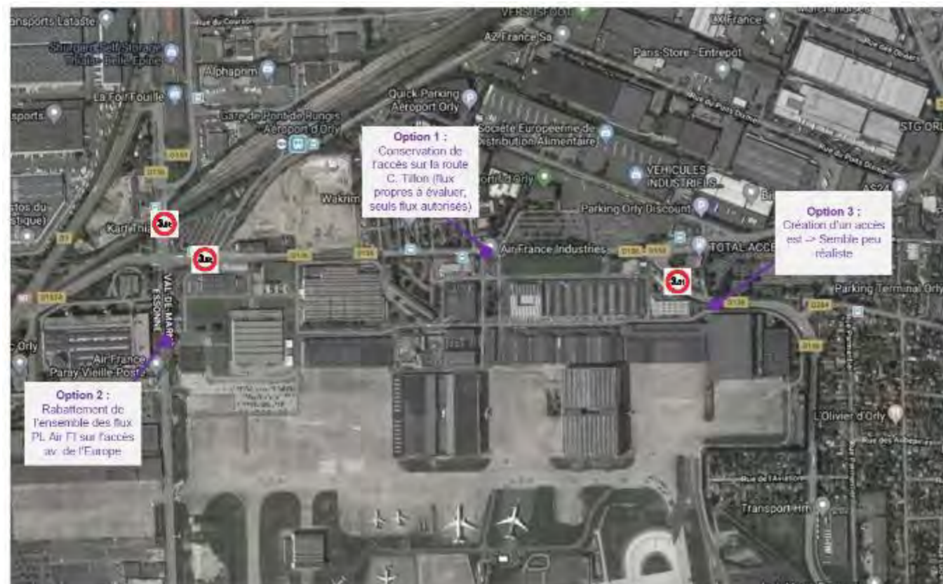
Figure 443 : Restrictions d'accès PL à la zone du Sénia- Points d'interdiction d'accès aux PL supérieurs à 3,5 T, sauf services et transport
