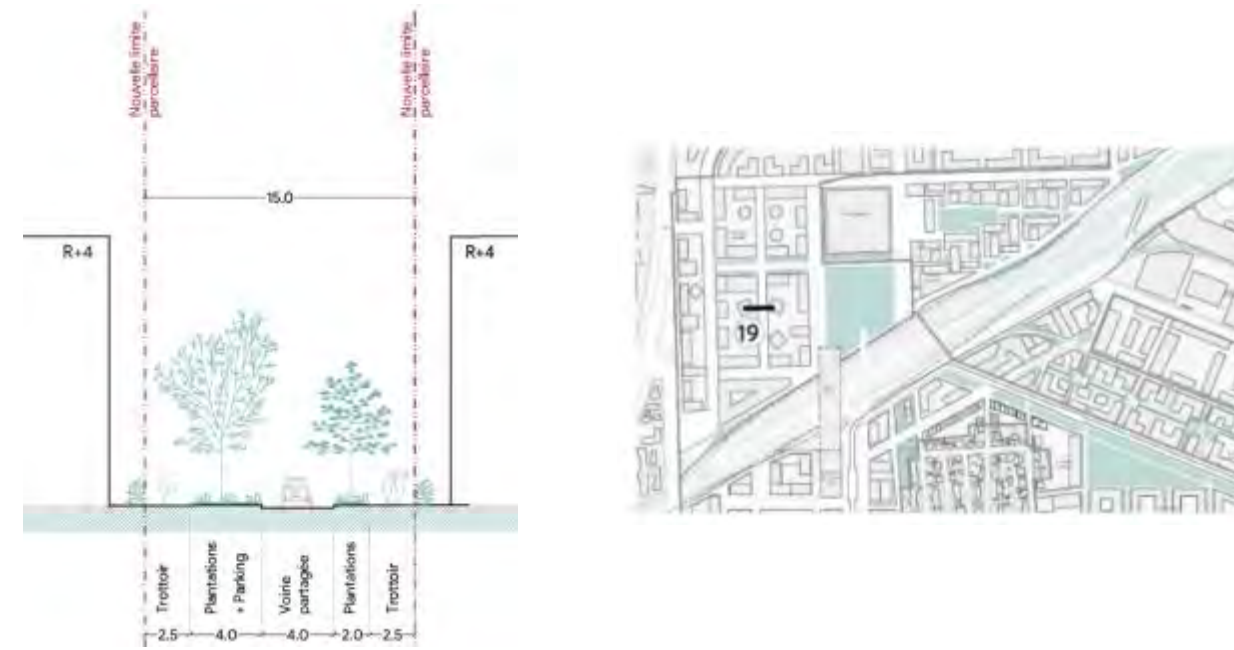
Figure 267 : Profil projeté pour une venelle à créer dans le quartier mixte de Thiais
