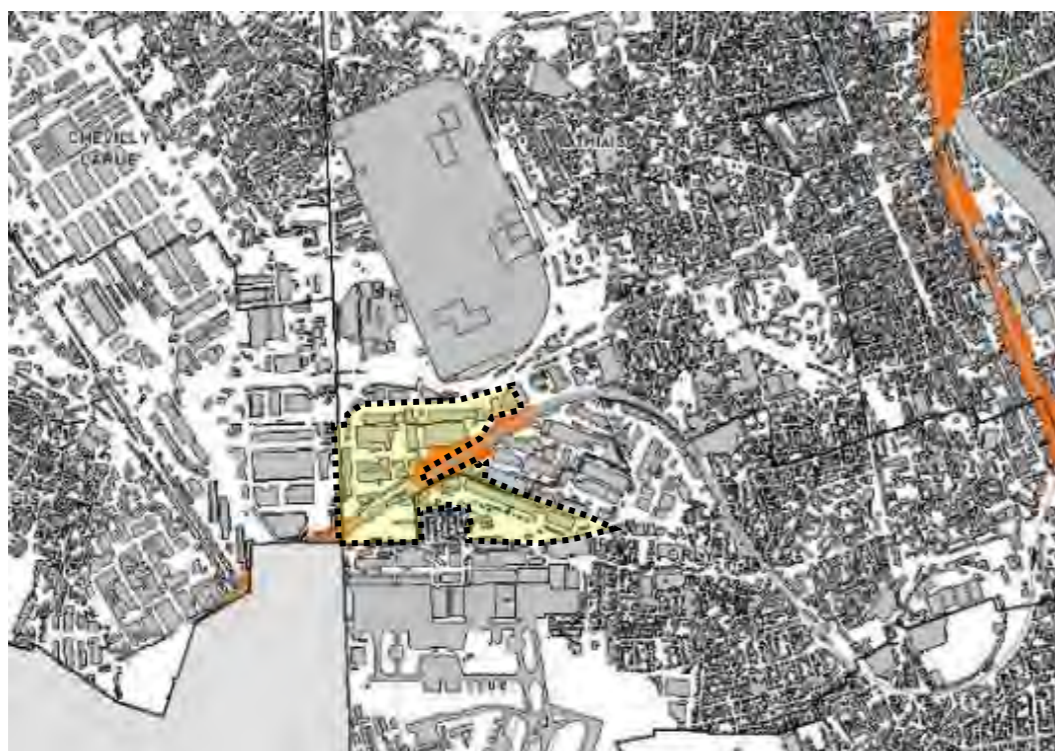
Figure 194 : Carte du bruit ferroviaire – Réseau RFF – Trafic supérieur à 60 000 passages de trains/an – Zones de dépassement des seuils >73 dB(A) (jour, soirée et nuit) (PPEB, 2012)
