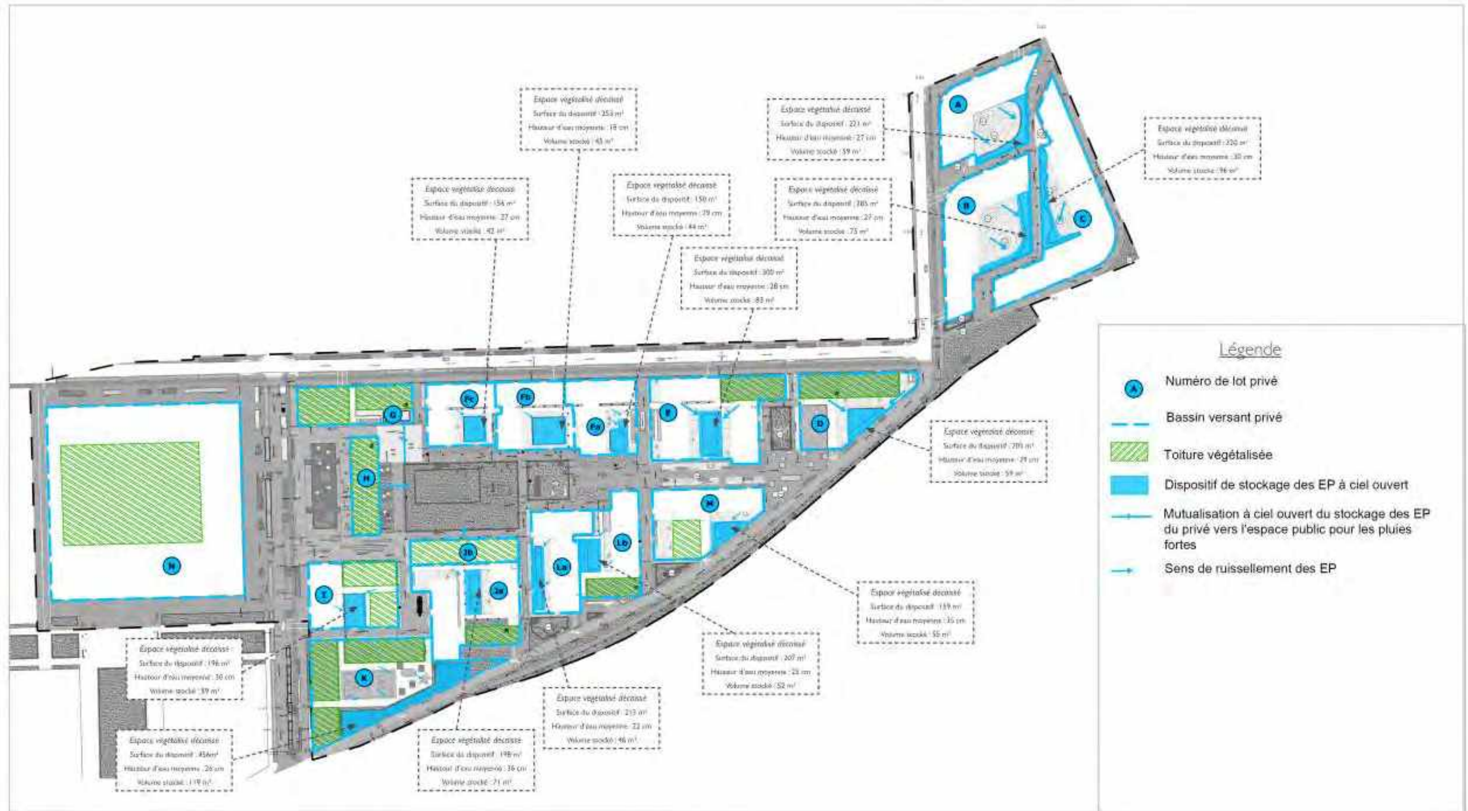
Figure 314 : Principe de gestion des eaux pluviales sur les lots privés -Secteur 1Thiais (source ATM)
