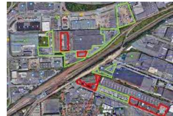
Figure 174 : Localisation des zones amiantées et non amiantées (légende : rouge : zone amiantée, vert : zone déclassée, flèches : point de prélèvement)
