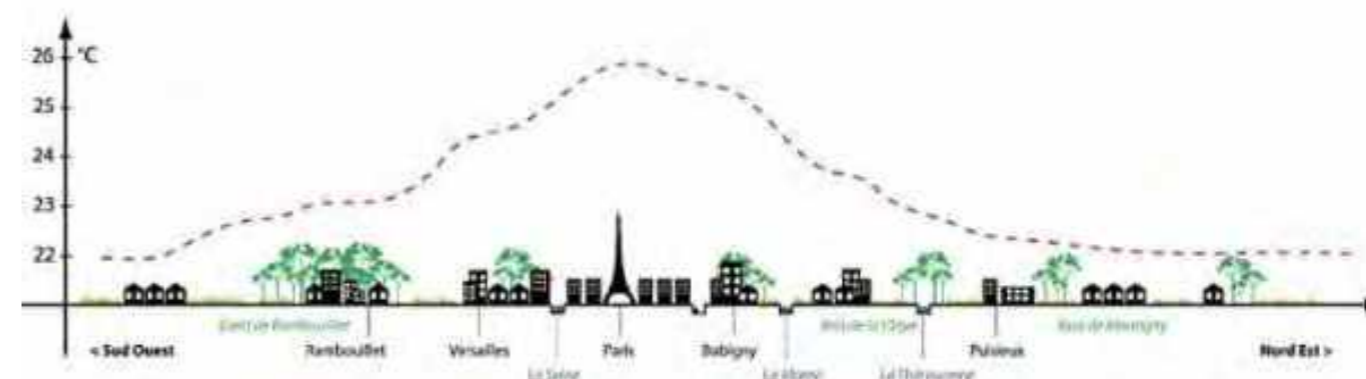
Figure 207 : Coupe schématique des températures en 2008 pour une nuit de canicule (type été 2003)
