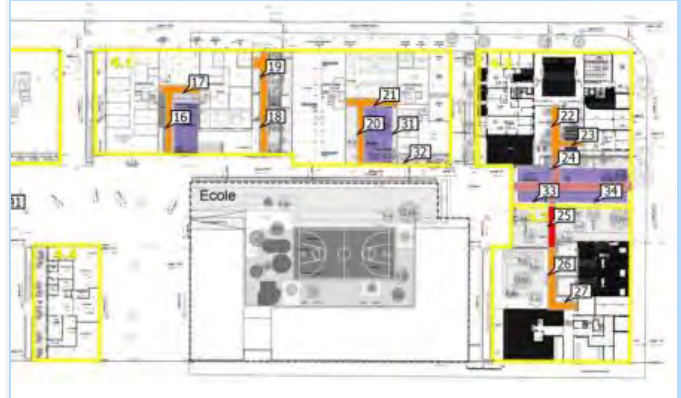
Emplacement des lampadaires (Source : TMC innovation)
