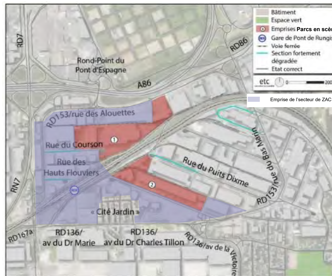
Figure 129 : Localisation des sections de chaussée fortement dégradées pouvant se révéler dangereuses
