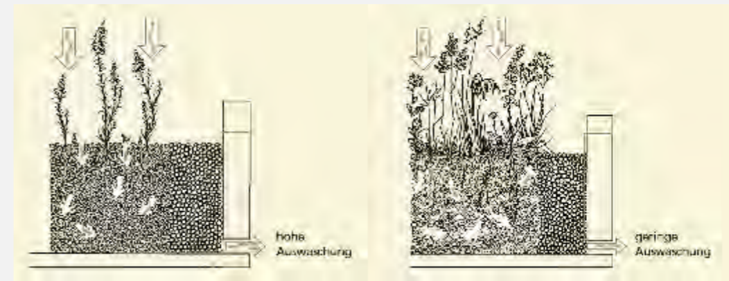
Circulation de l'eau et des nutriments dans un substrat industriel (à gauche) et naturel (à droite) (©Naturschutz auf Dachbegrünungen in Verbindung mit Solaranlagen)
