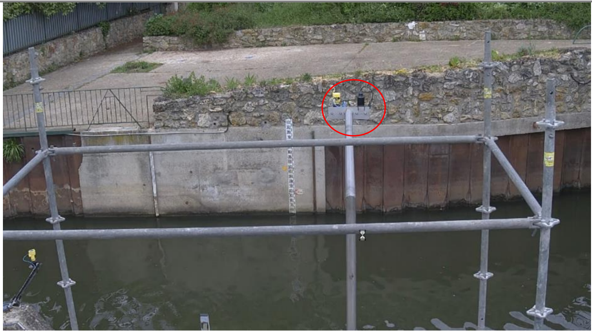
Image de la caméra autonome – Visualisation de la potence et du point de mesure E.32 – Athis-Mons – Syndicat de l'Orge
