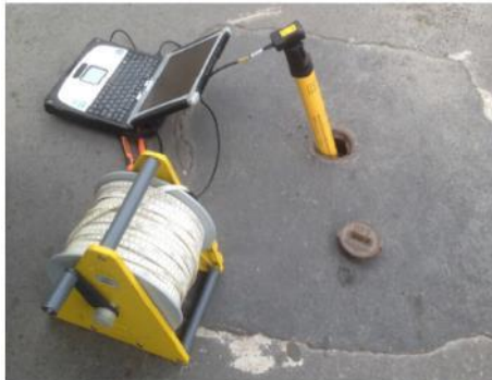
Figure 1 : Configuration d'un dispositif de mesure du niveau de la nappe en télé-réflexe
